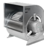
CBD/EC Ventiladores centrífugos de doble aspiración, motor directo EC Technology IE4 con electrónica integrada y turbina a acción
