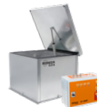
48 KIT BOXSMART FLAP Sistema de presurización de escaleras o vías de evacuación. Mantiene una presión diferencial de 50 Pa en una sola etapa, diseñados según la norma europea EN 12101-6
