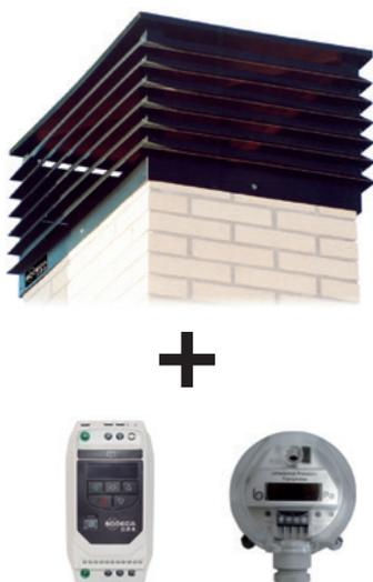
Conçus spécialement pour l'extraction mécanique contrôlée par le biais de cheminées ou de conduits collectifs. Le système permet de maintenir une pression constante dans l'installation en régulant automatiquement la vitesse de l'extracteur, ce qui permet d'obtenir le débit nécessaire à chaque instant, en fonction des différents besoins de l'installation, et de réaliser des économies d'énergies importantes.
