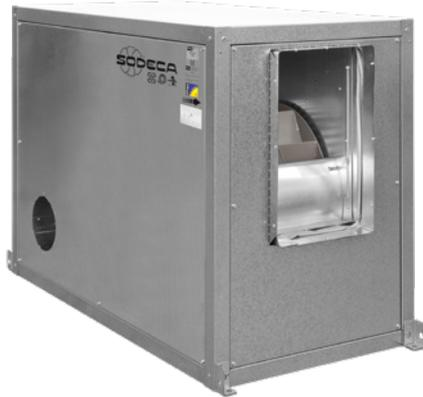
Unités d'extraction 400 °C/2 h à transmission avec turbine à réaction, équipées d'un moteur électrique, d'un ensemble de poulies, courroies et protecteurs conformes à la norme ISO-13857.
