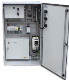
Équipement de pressurisation des voies d'évacuation en cas d'incendie conçu selon la norme européenne EN 12101-6. Le KIT BOXPDS SMART régule automatiquement le débit d'air et est capable de maintenir une surpression de 50 Pa même en présence de fuites dans l'installation. Le système est capable de maintenir une surpression (critères de pression) et d'atteindre 90 % du débit requis dans les 3 secondes suivant l'ouverture ou la fermeture d'une porte (critères de débit d'air).
