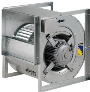
Extracteurs centrifuges double ouïe avec moteur direct pour fonctionner immergés dans des zones à risque d'incendie 400 °C/2h et 300 °C/2h, avec possibilité de moteur monophasé.
