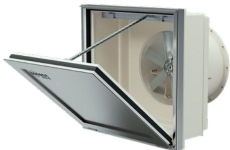
Extracteurs muraux dynamiques à ouverture motorisée, avec possibilité de raccordement à un conduit d'extraction. Spécialement conçu pour l'évacuation rapide et efficace des fumées et des gaz nocifs en cas d'incendie. Convient pour une installation dans des bâtiments industriels, des bâtiments commerciaux ou tout autre type de bâtiment. Homologation de l'ensemble complet selon la norme EN-12101-3, avec certification F400 et F300. Il peut être utilisé pour la ventilation de la pièce.
