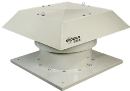
Extracteurs de toiture multifonctionnels 400 °C/2h et 300 °C/2h, pour travailler en immersion dans les zones à risque d'incendie, conçus pour l'évacuation des fumées dans les bâtiments industriels ou similaires.
