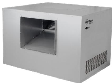
Unités d'extraction 400 °C/2h avec moteur et transmission hors flux d'air. Pour travailler à l'extérieur de la zone à risque d'incendie.
