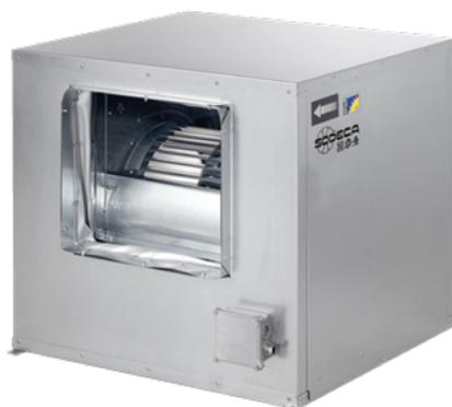
Appareils d'extraction et extracteurs centrifuges double ouïe avec moteur direct pour fonctionner immergés dans des zones à risque d'incendie 400 °C/2h, avec possibilité de moteur monophasé.
