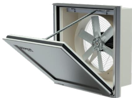
Extracteurs muraux dynamiques à ouverture motorisée, avec possibilité de raccordement à un conduit d'extraction. Spécialement conçu pour l'évacuation rapide et efficace des fumées et des gaz nocifs en cas d'incendie. Convient pour une installation dans des bâtiments industriels, des bâtiments commerciaux ou tout autre type de bâtiment. Homologation de l'ensemble complet selon la norme EN-12101-3, avec certification F400 et F300. Il peut être utilisé pour la ventilation de la pièce.
