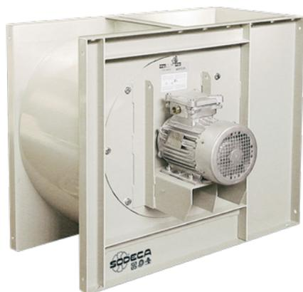
Extracteurs centrifuges pour travailler en immersion dans les zones à risque d'incendie 400 °C/2h, moyenne pression et simple ouïe. Très robuste. Equipé d'une turbine à réaction.
