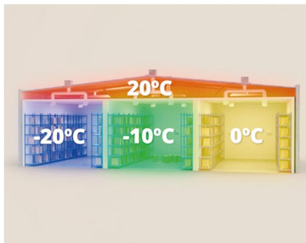
L'existence de basses températures à l'intérieur de la chambre froide peut réduire la flottabilité des fumées et gêner leur évacuation. C'est pourquoi les systèmes d'extraction mécanique sont présentés comme l'option offrant les meilleures garanties opérationnelles.
