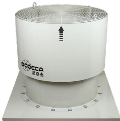
Extracteurs de toiture hélicoïdes avec sortie d'air verticale, pour travailler en immersion dans les zones à risque d'incendie, conçus pour l'évacuation des fumées dans les bâtiments industriels ou similaires.
